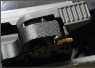
Möchten Sie die Kamera wieder abnehmen, klappen Sie zunächst den Sicherungshebel nach oben. Halten Sie nun die Kamera mit einer Hand fest, dann ziehen sie den grauen Arretierungshebel nach oben. Die Kamera löst sich nun vom Adapter.
