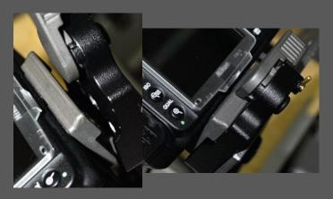
Bei erfolgreicher Durchführung schnappt der graue Arretierungshebel selbstständig nach rechts. Klappen Sie nun den kleinen goldfarbenen Sicherungshebel nach rechts ( siehe unten). Dieser verhindert ein versehentliches Lösen des Arretierungshebels.
